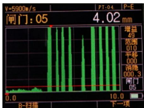
图 3.11 用 PT04 探头测薄板的波形图
