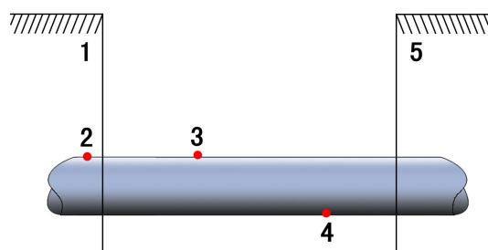
图17 管道防腐层破损处开挖验证示意图
