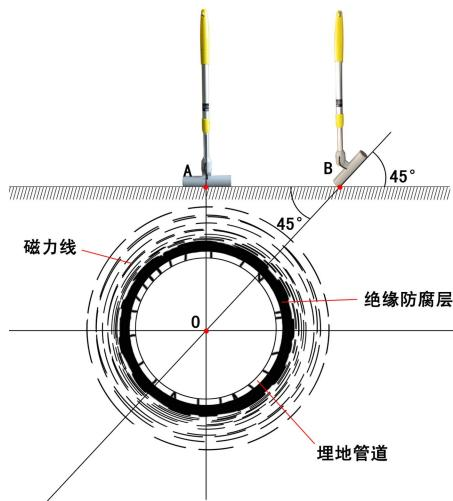
图10 管道45° 法测深图
