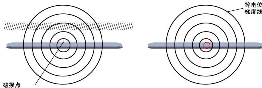
图11 地下破损点电位梯度立面分布图
