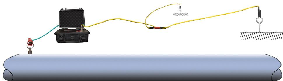
图7 远接地回路示意图
