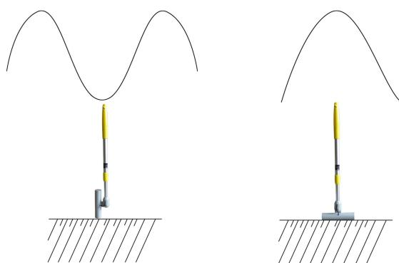
图8 零值法探测示意图
